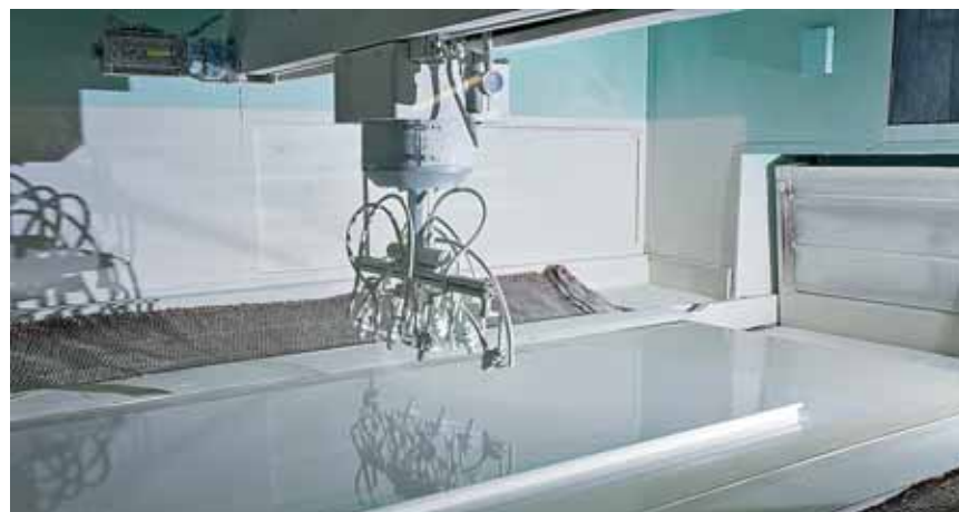
Der Lackierroboter bei Garant ist dank der Luftaufbereitungstechnik von Hauptkorn in der Lage, einen nahezu oversprayfreien Lackiervorgang durchzuführen, rechts die Qualitätskontrolle
